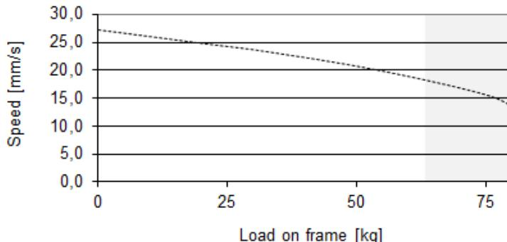
Die oben angezeigte Kurve bezieht sich auf eine mittig platzierte Last und ist nur gültig in Bezug auf die Einschaltzeit: 10% bei 50% der maximalen Nutzlast oder maximal 2 Minuten ohne Unterbrechung. Die oben angegebenen Daten können je nach Raumtemperatur, Luftfeuchtigkeit und Anschlußspannung variieren.
