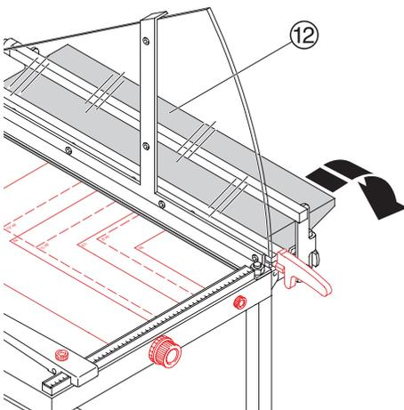
**DE** Das Papier kann auch am Vorderanschlag mit Schmalschnitt-Einrichtung **⑧** angelegt werden. Das gewünschte Maß läßt sich am Skalendrehknopf **⑩** einstellen und kann bei Wiederholungsschnitten mit der Arretierschraube **⑪** fixiert werden. Auch Schmalschnitte (kleiner 10 mm) sind möglich, da der Vorderanschlag bei Schnittausführung automatisch wegklappt.
