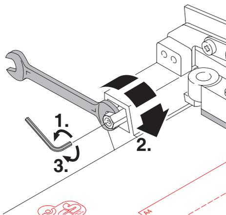
**FR** La machine est équipée d'un **frein** sur le levier de coupe, qui l'empêche de s'abaisser de lui-même dans toute position. Si le cas se produisait, le frein doit être réglé de la manière suivante:
