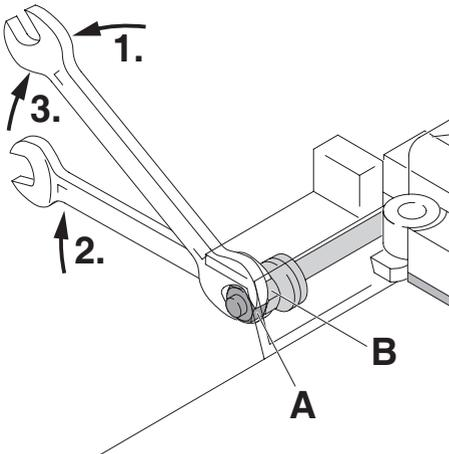
**DE** Die Maschine ist mit einer **Friktionseinrichtung** am Messerhebel ausgerüstet. Sie verhindert, daß der Messerhebel sich aus einer angehobenen Stellung selbständig nach unten bewegt. Ist dies dennoch der Fall, so muß die Friktionseinrichtung wie folgt nachjustiert werden:
