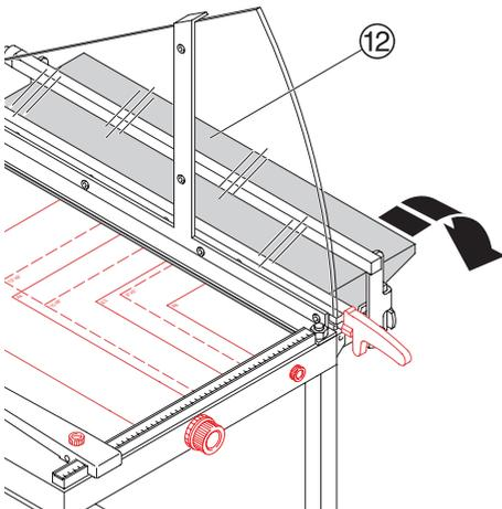
**IT** La carta può essere posizionata anche a filo con la battuta anteriore dotata di dispositivo per rifili millimetrici (8). La manopola graduata (11) consente di determinare con precisione la misura di taglio desiderata, può essere fissata tramite la vite di regolazione per eseguire tagli multipli. I rifili millimetrici (meno di 10 mm) sono possibili grazie allo spostamento automatico della squadra di battuta anteriore durante il taglio.
