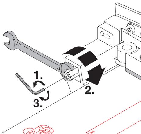
**IT** La lama è dotata di un **dispositivo di frizione** che ne impedisce la discesa involontaria. In caso si verificano problemi di questo tipo, la frizione può essere regolata seguendo le istruzioni riportate qui di seguito.
