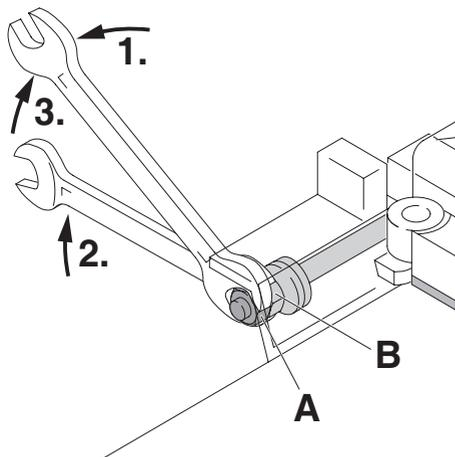
**ES** La máquina tiene un **sistema de fricción** en el portacuchillas. Este asegura que el portacuchillas no se pueda mover hacia abajo solo. Si el portacuchillas no está en su posición y se mueve solo, por favor reajustar el sistema de fricción inmediatamente.
