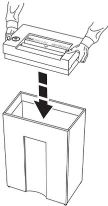
**DE** Maschine in den Auffangbehälter setzen.
