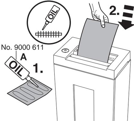
**ES** Si la capacidad de hojas se reduce o si la receptáculo está llena, recomendamos que lubrique el mecanismo destructor! (mirar dibujo) Para el modelo de corte en tiras utilizar el bote de aceite (**A**)
