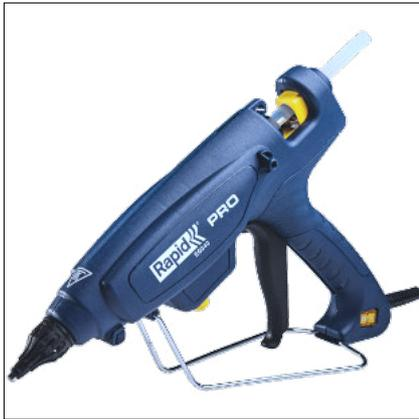
Professionelle/industrielle Schmelzklebepistole mit hoher Kleberfördermenge. Mechanischer Thermostat. Einstellbare Temperatur für unterschiedliche Anwendungen. 4-Finger-Vorschubhebel für hohen Bedienkomfort. Heizpatronensystem für große Zuverlässigkeit. Incl. festem und klappbarem Standbügel für vielseitige Einsetzbarkeit. Kurze Aufheizzeit und Ein/Aus-Schalter. Verschiedene Düsen als Zubehör erhältlich.
