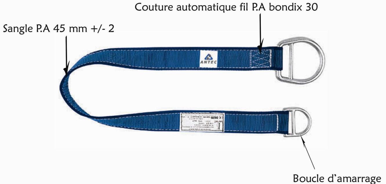
**Produit et utilisation :** Point d'ancrage mobile, polyamide, à utiliser avec un système antichute conforme EN 353/2, EN 355, EN 360. Le point d'ancrage doit être positionné au dessus de l'utilisateur.
