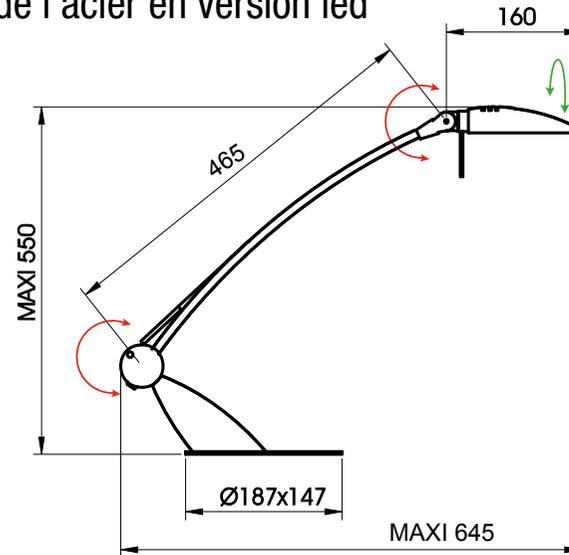
La lampe de bureau SWINGO associe la fluidité du métal à l'élégance du bois. Bras articulé sur socle en bois massif. Réflecteur orientable. Interrupteur tactile sur le socle pour régler 3 niveaux d'intensité lumineuse. Module LED intégré.
