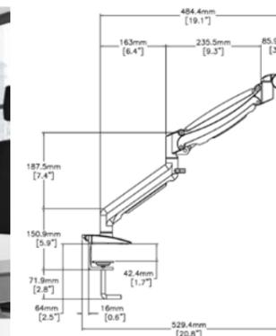
Montage possible grâce à une perforation de 60 mm dans le plateau de table
