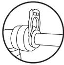
**IMPORTANT ! TOUJOURS S'ASSURER QUE LES CLIPS DE SÉCURITÉ SONT INSTALLÉS SUR TOUTS LES RACCORDS D'EAU ET DE CO2.**
