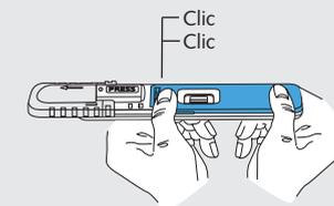
4. Replacer la spatule de prélèvement sur le boîtier réactif. **Un déclic doit se faire entendre pour indiquer que les éponges de prélèvement sont correctement enclenchées.**
