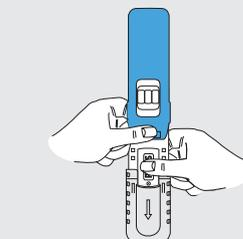
5. Placer le boîtier réactif en position verticale, l'ampoule vers le bas. **Appuyer fortement avec le pouce sur le bouton PRESS bien au milieu et en tenant le test bien droit** jusqu'à ce que l'ampoule cède. Maintenir le boîtier réactif en position verticale durant encore **10 secondes** comme indiqué.
