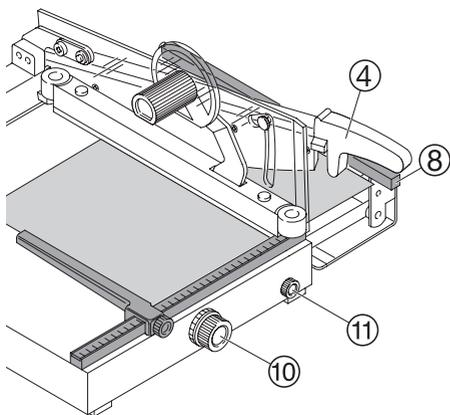
**NL** Het papier kan ook aan de vooranleg ⑧ gelegd worden. Gewenste maat instellen met de meettrommel ⑩ en kan bij snedes met dezelfde afmetingen vastgezet worden d.m.v. een schroef ⑪).
