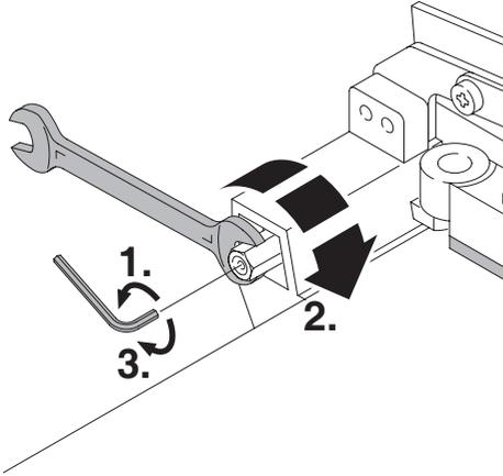
**DE** Die Maschine ist mit einer **Friktionseinrichtung** am Messerhebel ausgerüstet. Sie verhindert, daß der Messerhebel sich aus einer angehobenen Stellung selbständig nach unten bewegt. Ist dies dennoch der Fall, so muß die Friktionseinrichtung wie folgt nachjustiert werden:
