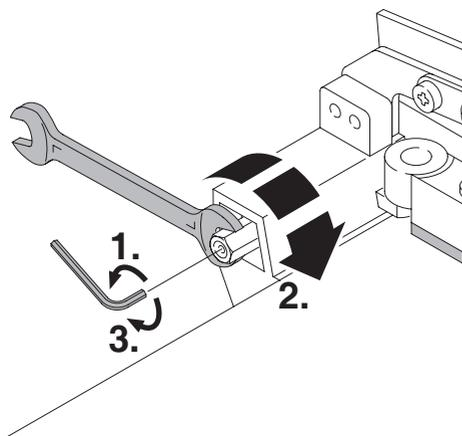
**NL** De machine is uitgerust met een **friectievoorziening** aan de meshouder. Deze zorgt ervoor dat de meshouder niet uit zichzelf neerwaarts beweegt. Indien dit toch het geval is, dan dient de friectievoorziening als volgt te worden nagesteld: Imbusschroef (1.) met een imbussleutel (maat 4) losmaken.
