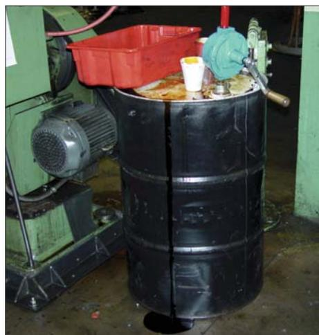
Plus d'écoulement des pompes glissant le long des fûts et sur le sol.
