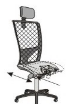
6 Réglage de la profondeur de l'assise / The seat depth adjustment
