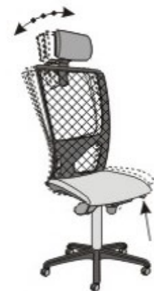
2 Déblocage du dossier / Synchronized free floating movement 3 Blocage du dossier / Synchron movement in locked position
