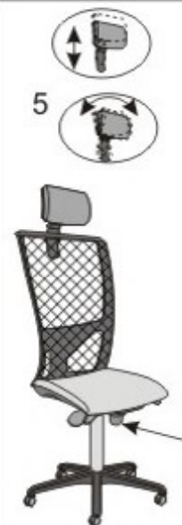
4 Volant de réglage de la tension du dossier / Tension adjustment knob
