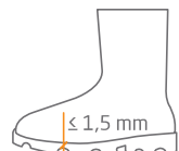
Wysokość wypukłości jest mniejsza niż 1,5 mm
