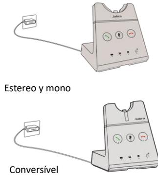
Em seguida, conecte a base a uma fonte de alimentação. Pressione os botões de aumentar e diminuir o volume em seu computador simultaneamente para acessar o menu de configuração que o ajudará a conectar seu computador ou telefone de mesa.
