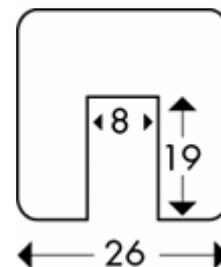
A proteção de canto, tipo G faz parte dos perfis de aviso e proteção com o nome característico Knuffi®. Esta proteção de canto funciona como secção deformável para a proteção de pessoas, máquinas e outros equipamentos, absorve choques violentos e evita assim ferimentos ou danos materiais de forma eficaz.
