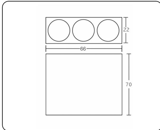
**DESCRIPCIÓN:** Papelera metálica selectiva de residuos. Tapa superior desmontable con tres aperturas identificadas por colores. Tres cubetas interiores extraíbles para su vaciado. Embellecedor negro en la base.
