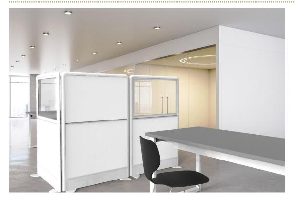
**ESTRUCTURA:** Se construye con perfil perimetral de extrusión de aluminio de 85x50 mm. Todos los perfiles de aluminio van ranurados y reforzados con junta de goma para poder encajar fácilmente el interior del panel. Las esquinas del panel van unidas con escuadras de chapa de 3 mm de espesor.
