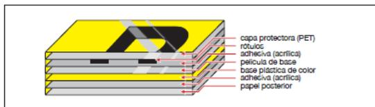
Las cintas laminadas TZe de Brother P-touch constan de seis capas de material, dando como resultado una etiqueta muy fina y extremadamente fuerte. Los caracteres se forman con una tinta de transferencia térmica intercalada entre dos capas de protección de película de poliéster. El resultado es una etiqueta indestructible que puede soportar incluso las condiciones más adversas.
