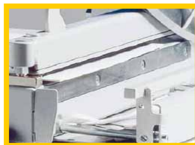
Tope lateral con dispositivo de corte estrecho regulable
