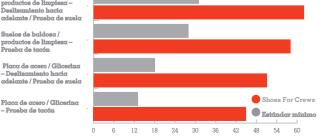
Prueba EN ISO 13287:2012 para determinar la resistencia al deslizamiento realizada por TUV Rheinland LGA Products GmbH en Leipzig, Alemania, en Agosto 2019. \*en una escala donde 0,0 es la ausencia de fricción y 1,0 corresponde a una fricción muy alta (por ejemplo, una alfombra seca), SFC registró 0,63 más de tres veces el estándar mínimo de 0,18. Todos los zapatos de SFC están equipados con suela deslizante patentada por Shoes For Crews. Producto probado: DOLCE81 76236
