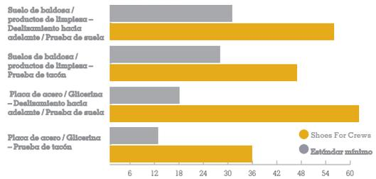
Prueba EN ISO 13287:2012 para determinar la resistencia al deslizamiento realizada por TÜV Rheinland USA Products GmbH en Leipzig, Alemania, en Agosto 2019. \*en una escala donde 0,0 es la ausencia de fricción y 1,0 corresponde a una fricción muy alta (por ejemplo, una alfombra seca). SFC registró 0,63 más de tres veces el estándar mínimo de 0,18. Todos los zapatos de SFC están equipados con suela deslizante patentada por Shoes For Crews. Producto probado: DOLCEBI 76236
