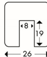
La protección para esquinas del tipo G es uno de los perfiles de advertencia y protección con el nombre característico Knuffi®. Este perfil de esquina actúa como zona flexible de protección para las personas, las máquinas y los materiales, absorbe impactos fuertes y evita así de forma eficaz lesiones y daños materiales.
