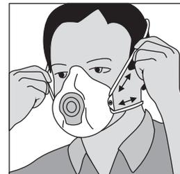
4. Para asegurarse un buen ajuste tirar de la correa hacia un lado u otro.
