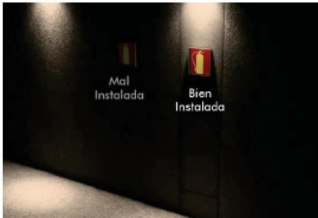
La señalización de los medios manuales de extinción se realizara siempre que sea posible en la vertical del elemento a señalizar.
